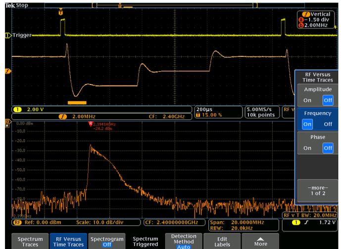
时域视图中的橙色波形是从频谱分析仪输入信号导出的频率随时间变化曲线。注意频谱时间位于从最高频率到最低频率的跳变过程中，因此能量分布到大量的频率中。过频率随时间变化曲线，可以简便地看到不同的跳频，简化了检定被测器件在不同频率之间怎样切换的过程。
