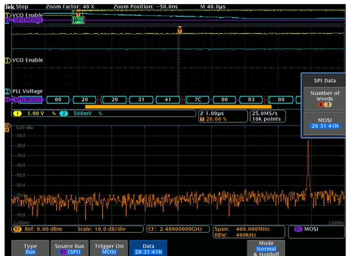
捕获 - 触发经过 SPI 总线的特定传输数据包。完整的一套触发功能，包括触发特定串行包内容，保证您能快速捕获关心的事件。
