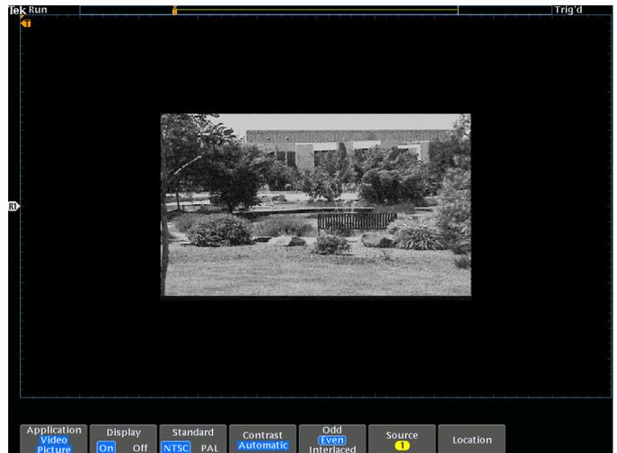
查看 NTSC 视频图像。视频图像模式包含对比度和亮度自动设置及手动控件。
