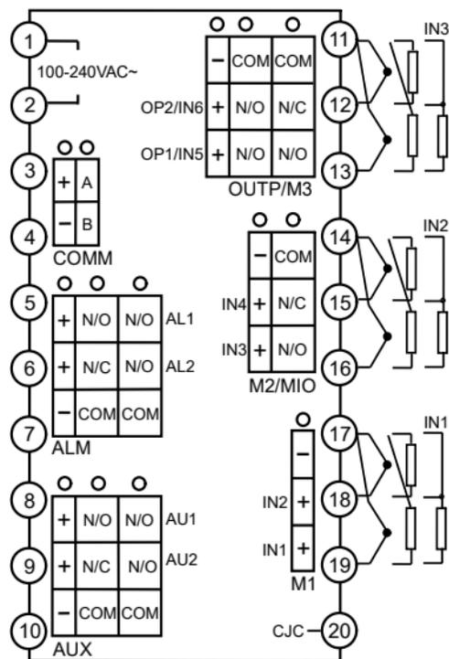
注：本图为 A、C、E 型竖式面板的式仪表接线图。
